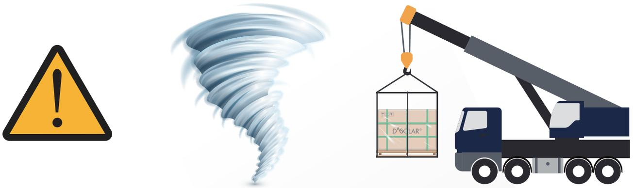
風力が6級(ビューフォート風力段階)を超える場合、大雨または大雪の気象条件下では、太陽光モジュールの吊り上げは厳禁です。水平梱包は一度に最大2パレットのモジュールを吊り上げるのが可能です。
