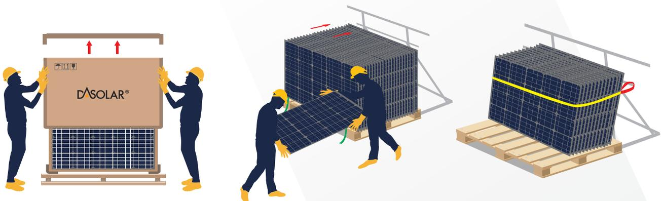
• 強風時にモジュールを運搬しないでください。また、開梱されたモジュールを必ず適切に固定ください。
